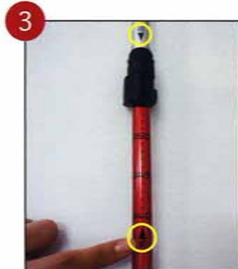
3 カムレバー上部の▼印と目盛の下にある▲印の向きを合わせる。
